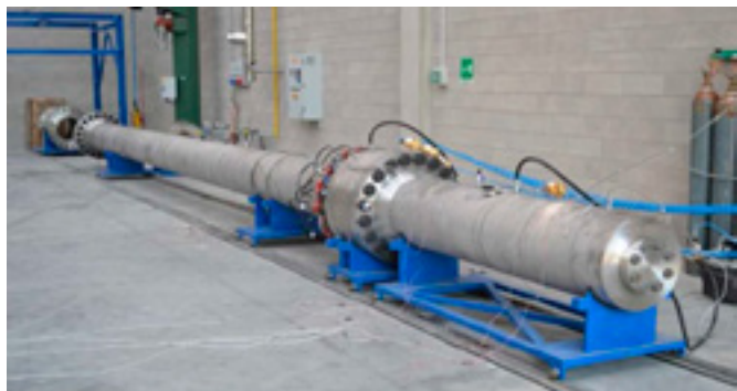
Shock tube at the laboratory of «Polo Territoriale di Lecco», Italy. Courtesy of M. Di Prisco.
